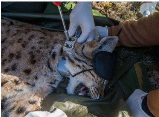
Slika 3: Telemetrična ovrtnica na risu z veznim členom iz bombaža, ki ob morebitni okvari mehanizma drop-off omogoča, da ovrtnica čez čas odpade z živali. Foto: Lan Hočevar
