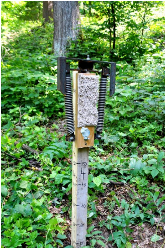
Slika 1: Prva različica vonjalne postaje z aktiviranim dvojnimi aktivnim vzmetnim lovilcem, pasivnim lovilcem, atraktantom, oznako lokacije v ogradi in višinsko skalo (Smolej, 2018).
