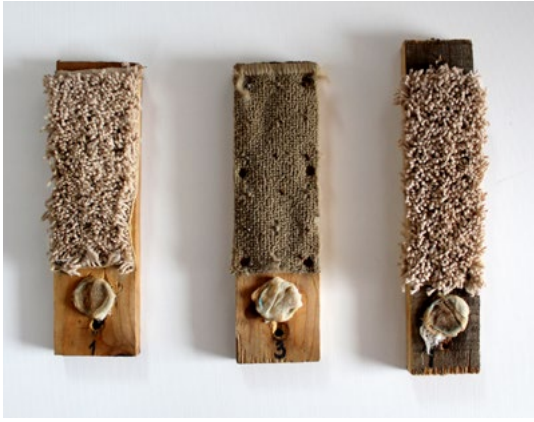
Slika 3: Prva, druga in tretja različica pasivnega lovilca za dlake (od leve proti desni) (Smolej, 2018).
