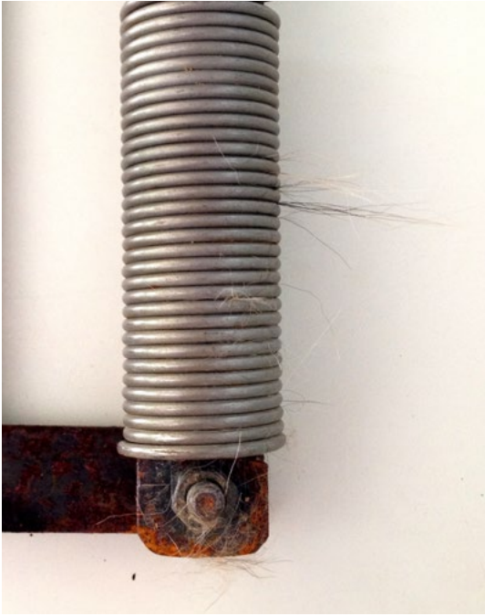
Slika 5: Sprožena vzmet na dvojnem aktivnem vzmetnem lovilcu oziroma prvi različici. Sprožena je bila desna vzmet, ki je skupno zadržala 565 dlak, od katerih je bilo v vzorcu 306 dlak z dlačnimi mešički (54,2 %).
